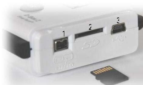
1: Conexión para el cable del tacógrafo
